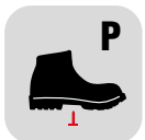
RESISTENZA ALLA PERFORAZIONE inserto metallico chiodo diametro 4,5 mm
