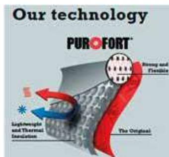
Purofort è il materiale unico Dunlop con milioni di sacche d'aria uniformemente distribuiti rendendolo leggero e termicamente isolante più una struttura reticolata che fornisce la flessibilità e la resistenza.
